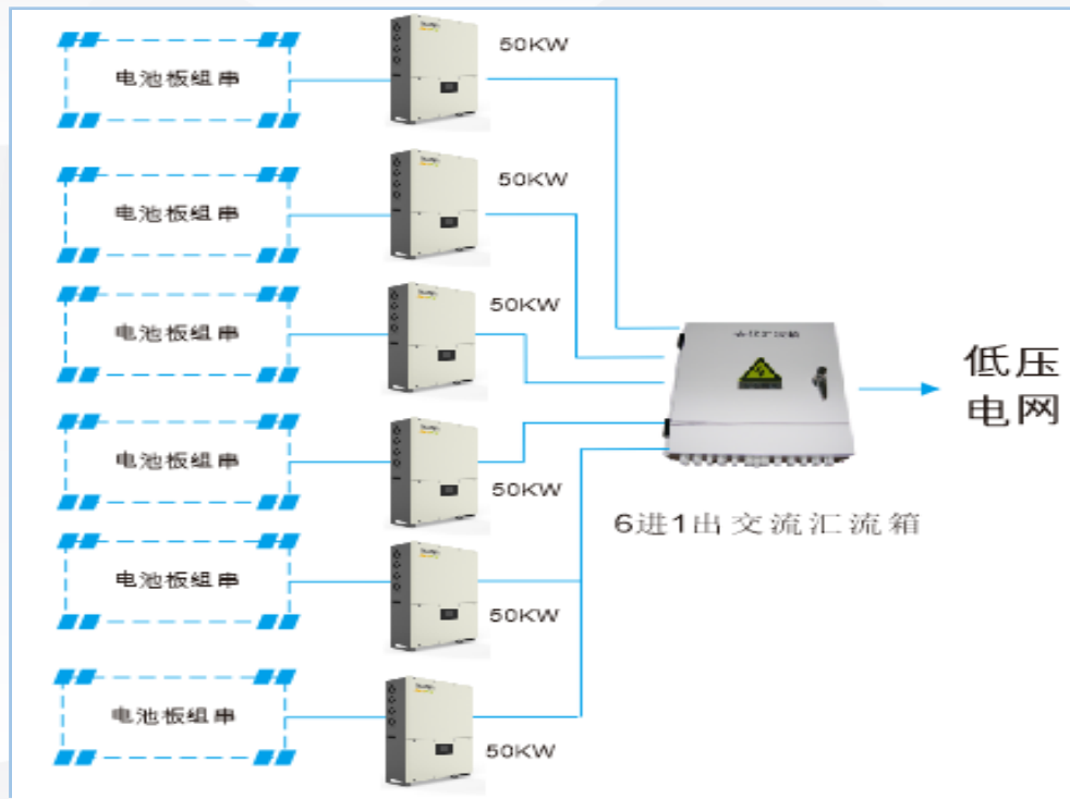
300KW村级扶贫电站系统图
